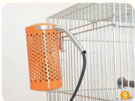
9 鳥さんの入っていない状態で電源を入れてみます。数分経って電球内部の熱線が少し赤くなり、温度が上がれば動作OKです。また、電源コードが熱を持っていないかも確認します。
